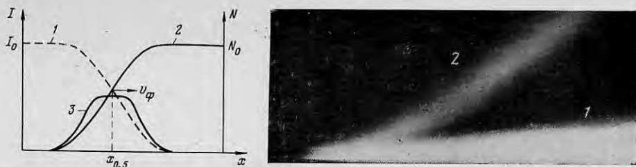
Рис. 1. a – Профили: 1 – потока излучения во фронте волны просветления, 2 – концентрации исходных молекул, 3 – профиль скорости накачки Q = \sigma_n N I . Излучение накачки распространяется вдоль оси x . v_\phi = I_0/N_0 . б – фотохронограмма (щелевая развертка) развития разряда (1) и люминесценции XeF (2) во фронте волны фотодиссоциации XeF 2 (2)
